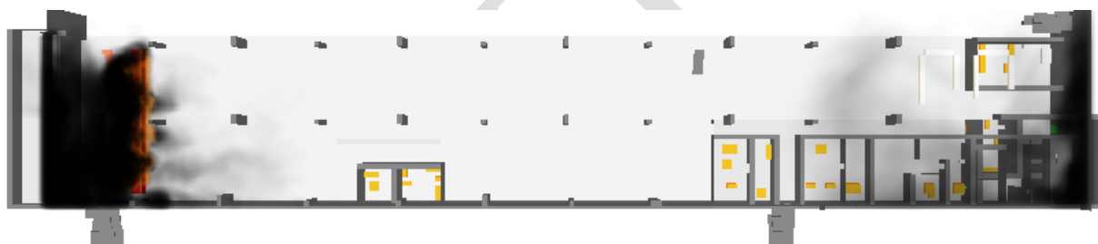
Рисунок 30. Мезонин. HCl на высоте 1,7 м от уровня этажа. Время: 102,6 с.
